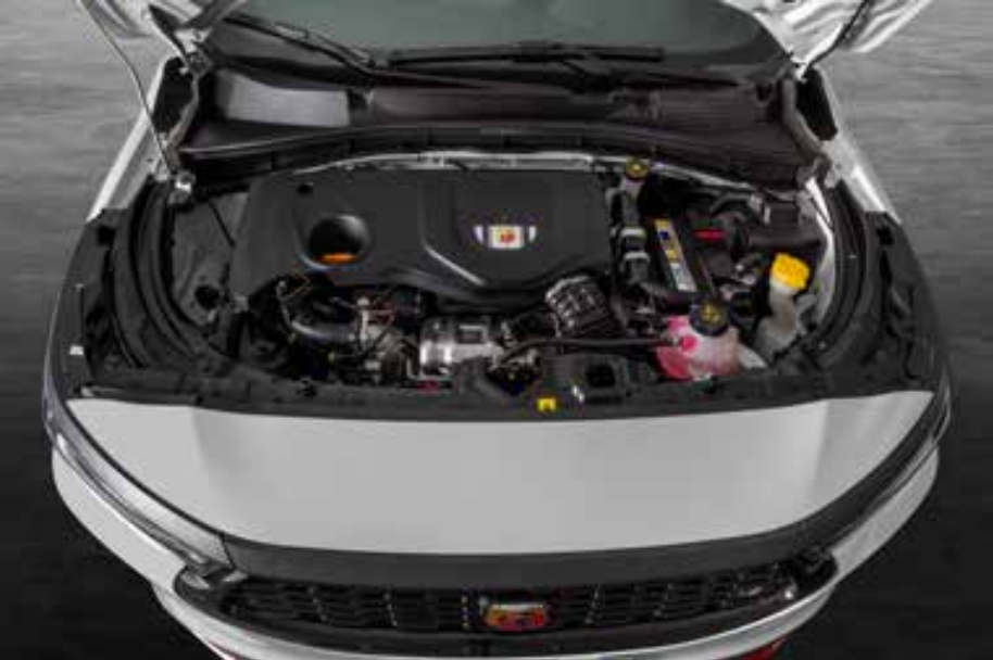
O motor é o T270 recalibrado, que gera 180 cv (gasolina) e 185 cv (etanol), além de 270Nm de torque nas duas situações
