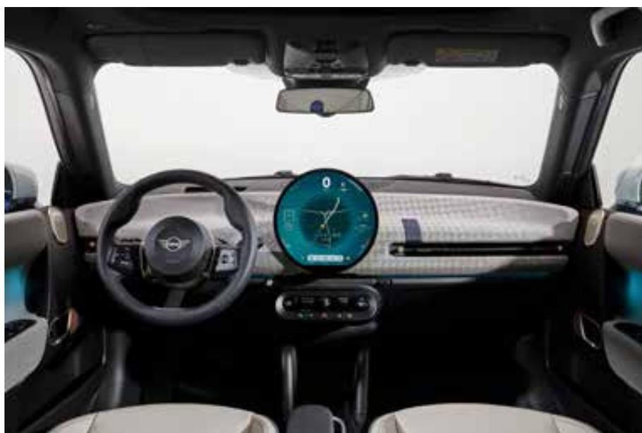
*A multimídia tem display OLED de 240 mm de diâmetro e muitas novas funções digitais adicionais no Pacote MINI Connected*
