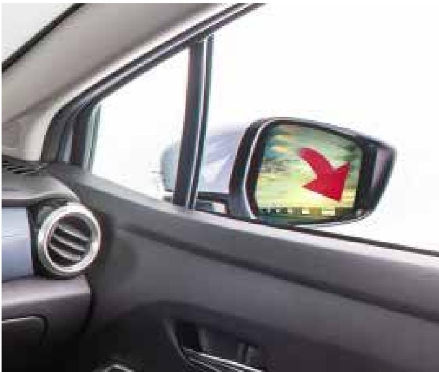
Um sistema automático de rebatimento do retrovisor permite que se visualize o meio-fio nas manobras de ré
