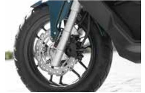
**A scooter possui freios a disco nas duas rodas e a dianteira possui 240 mm de diâmetro, tipo “wave” e sistema ABS**
