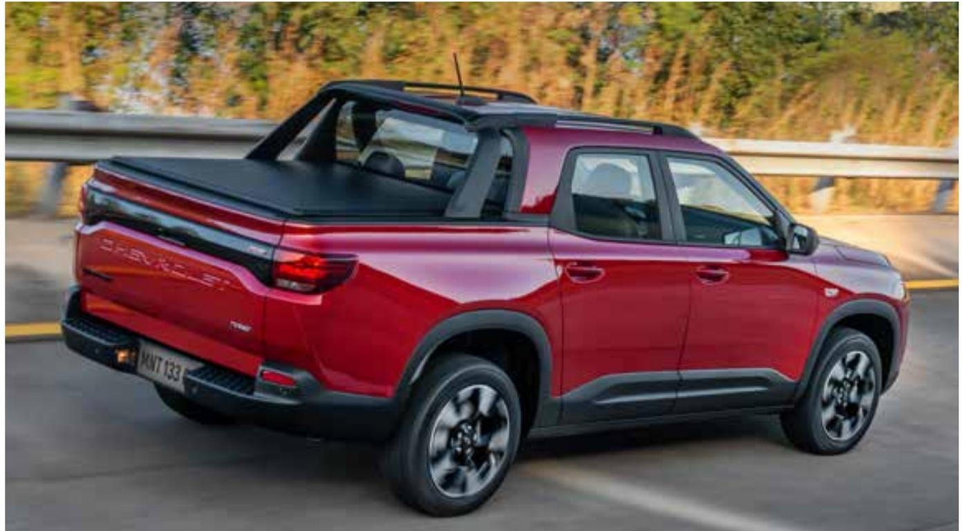
**O veículo recebeu motor 1.2 Turbo Flex com até 133 cv de potência e 21,4 kgfm de torque, suficiente para levar a Montana RS da imobilidade até 100 km/h, em 10,1 segundos**
