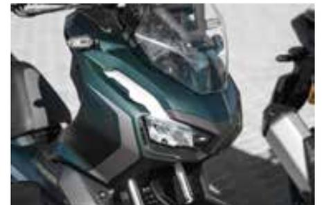
**A Honda ADV oferece chave presencial e painel LCD Black-Out, além de para-brisa ajustável em duas posições**
