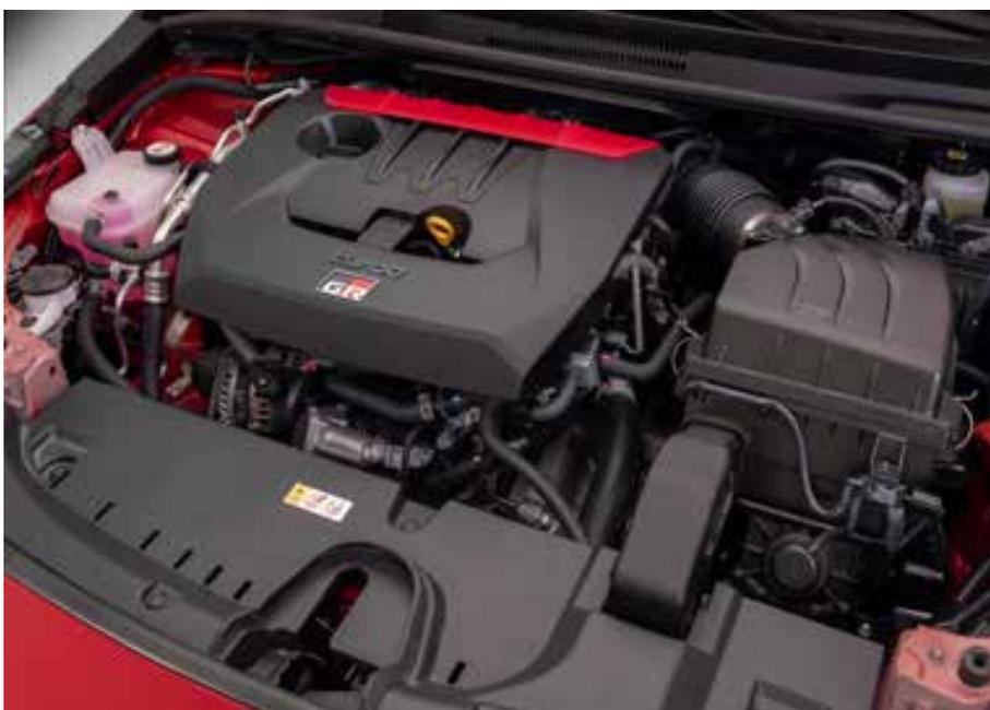
O GR Corolla recebeu o motor turbo intercooler de três cilindros em linha de 1,6L, com potência de 304 cv e 37,7 kgfm de torque
