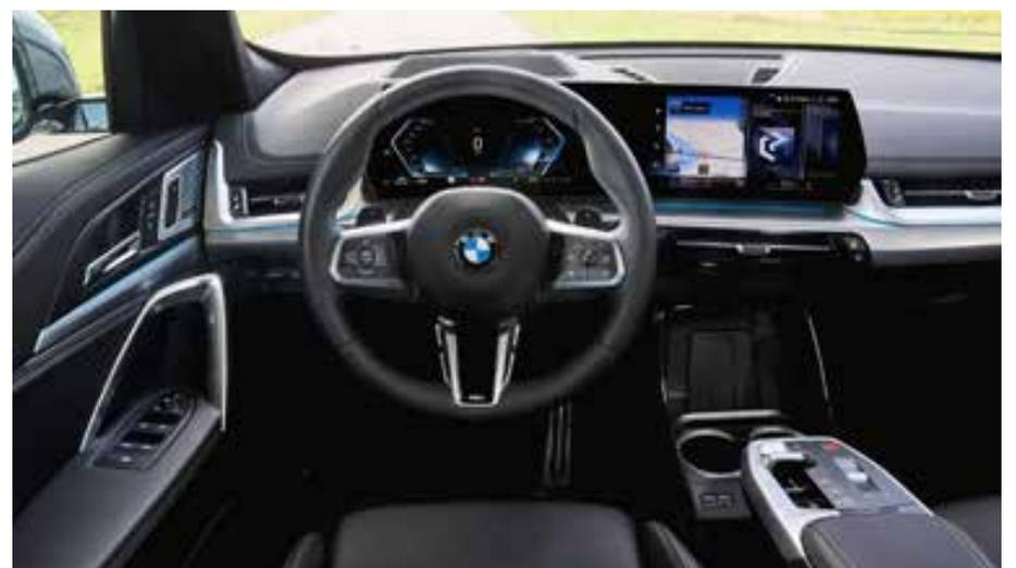
**O interior conta com tela curvada em TFT de alta resolução que incorpora duas outras: 10,2" (painel de instrumentos) e 10,7" (multimídia)**
