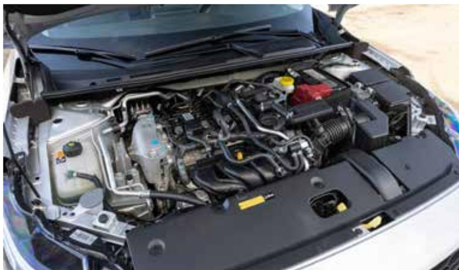
**Movido exclusivamente a gasolina, o motor desenvolve 151 cavalos de potência a 6 mil rpm e 20 kgfm de torque a 4 mil rpm**
