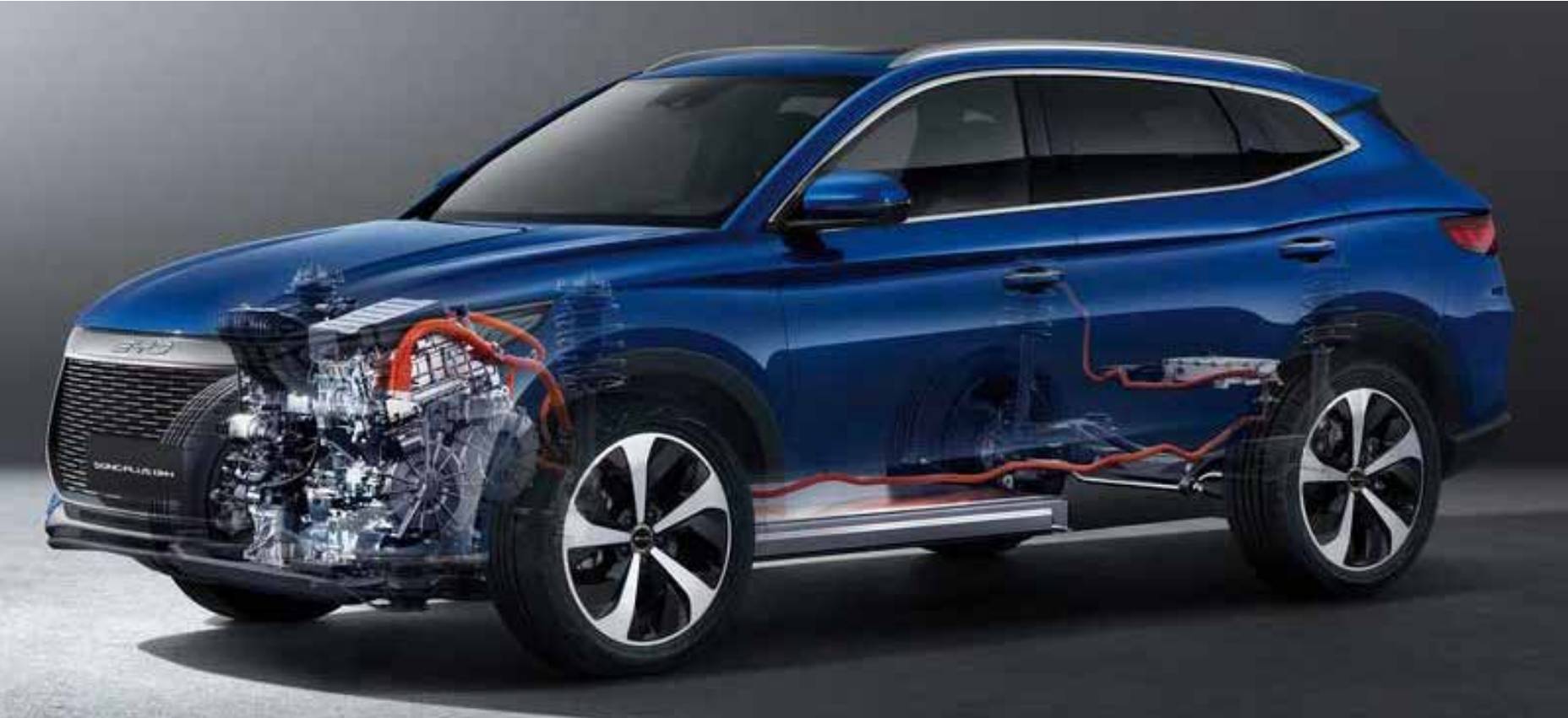
O Song Plus DM-i está equipado com dois motores: um a gasolina e outro elétrico produzindo uma potência combinada de até 235 CV e torque máximo combinado de 400 Nm
