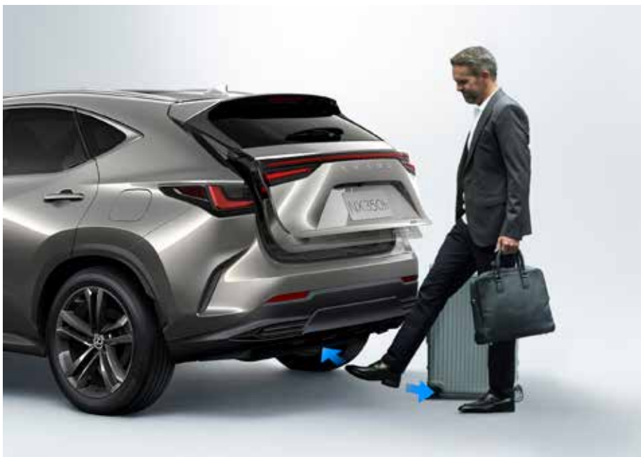
As portas se abrem lentamente através de motorização elétrica. A tampa do porta-malas pode ser aberta passando o pé por baixo do carro
