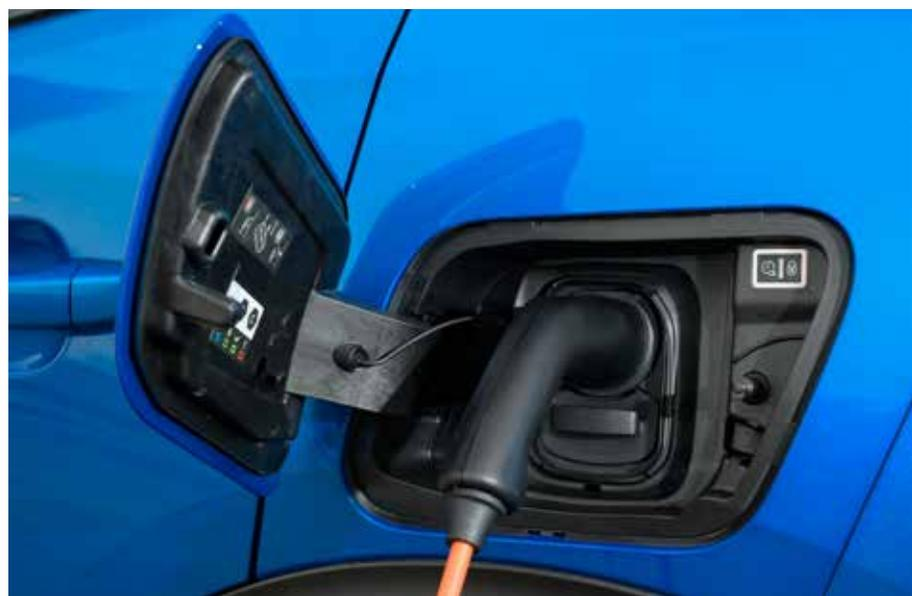
**O bocal de recarga da bateria fica posicionado na lateral, mesmo local onde um carro a combustão utiliza para abastecer**
