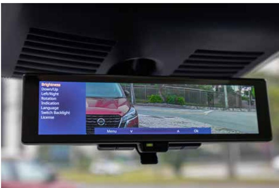
**Para facilitar a condução, o carro usa câmeras para reproduzir as imagens da traseira do veículo no retrovisor interno com tela de LCD**
