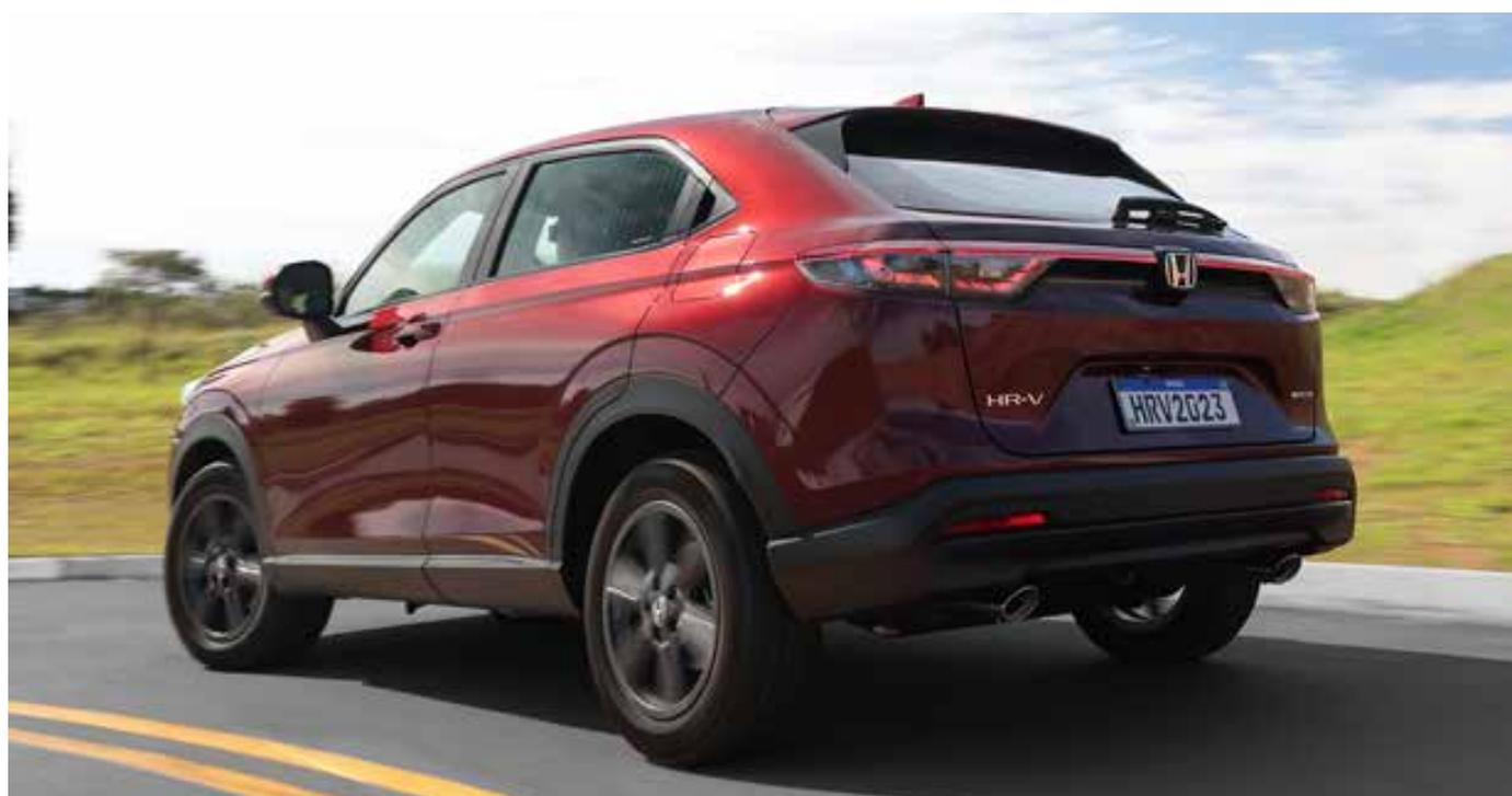
**A traseira do New Honda HR-V conta com lanternas fumê com LED unidas por uma barra horizontal de LED que também cumpre a função de luz de posição**
