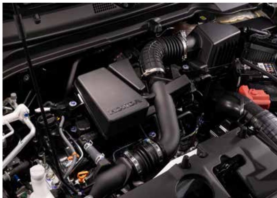
**As versões Advance e Touring ganharam motor 1.5 DI VTEC TURBO Flex, com injeção direta de alta pressão, que gera 177 cv de potência**
