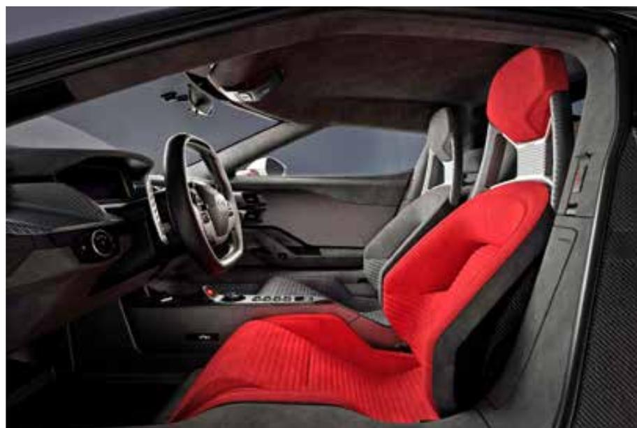
**O interior tem bancos de fibra de carbono revestidos em Alcantara e painel, pilares e teto com acabamento em couro**
