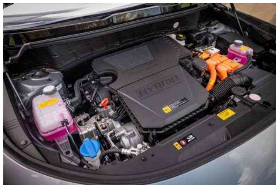
**Um motor 1.6 com injeção direta, à gasolina e outro elétrico proporcionam potência combinada de 141 cavalos a 5.700 rpm e torque de 27 kgfm**
