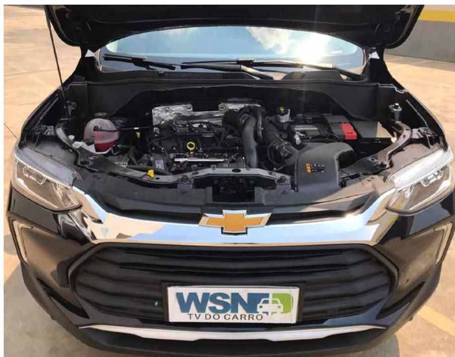
O motor 1.2 litro turbo é capaz de levar o SUV à velocidade de 185 km/h e faz de 0 a 100 em 9,4s
