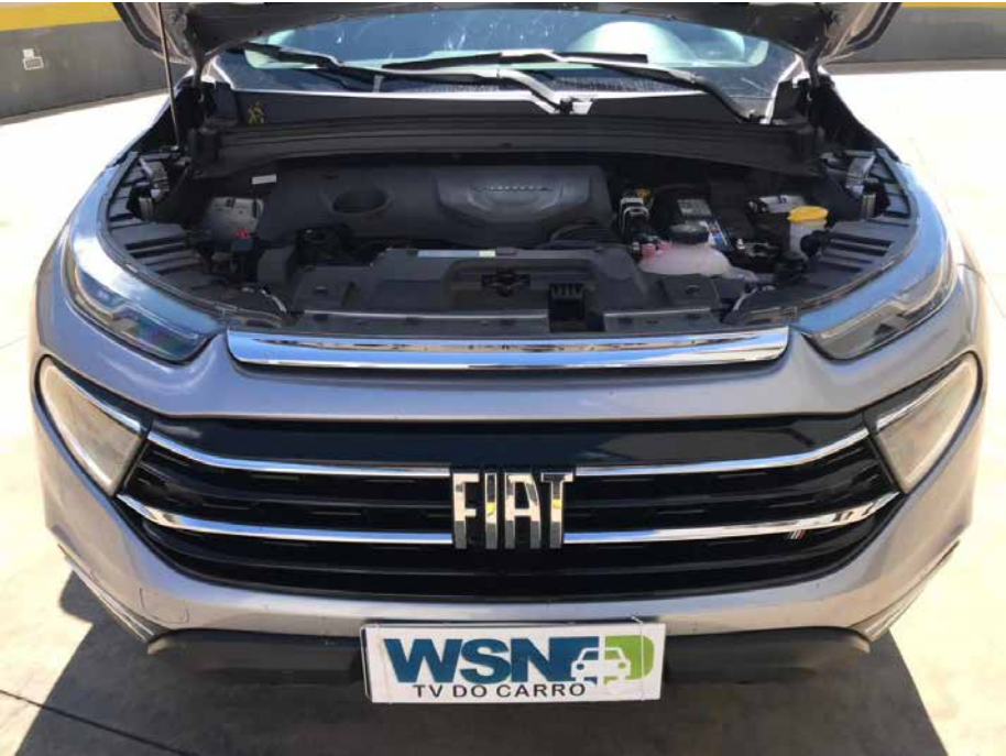
O motor Turbo 270 é um 4 cilindros flexfuel 1.3 litro que gera potência de 185 cv (E) e 180 cv (G)
