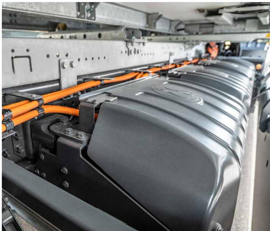
Um conjunto de baterias de alta performance se localiza na lateral do chassi, facilitando a manutenção
