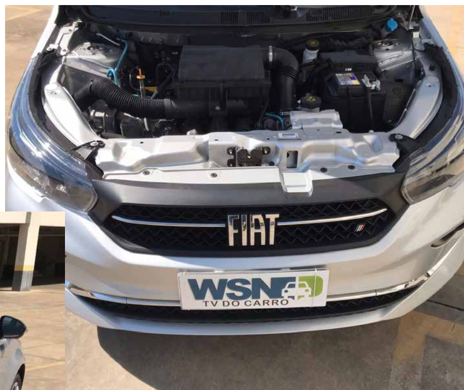
O Fiat Cronos Precision é equipado com motor 1.8 litro E.torQ de potência variando entre 135cv (G) e 139cv (E)
