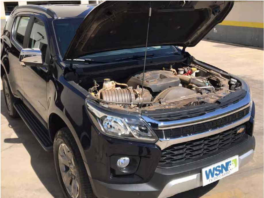
O motor turbodiesel 2.8 litros ficou mais silencioso, gerando 200cv de potência e torque de 51,0 kgfm
