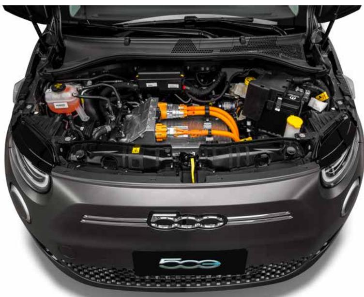
O motor elétrico gera 87 kW (118 cv) e torque que chega a 220 Nm (22,45 kgfm)
