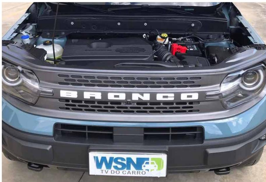
O motor 2.0 EcoBoost turbo com injeção direta gera 240 cv e 38 kgfm de torque, e acelera de 0 a 100 km/h em 8 segundos
