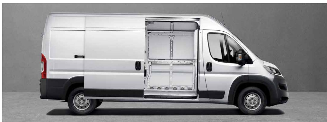
**O Furgão Citroën Jumper permite transportar cargas útil de até 13m<sup>3</sup> de volume e 1.311 kg de peso líquido**
