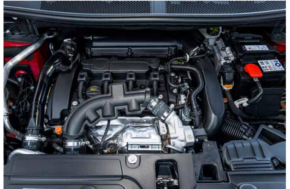
O motor turbo de alta pressão 1.6 litro gera 165 cv de potência e 24,5 kgfm de torque
