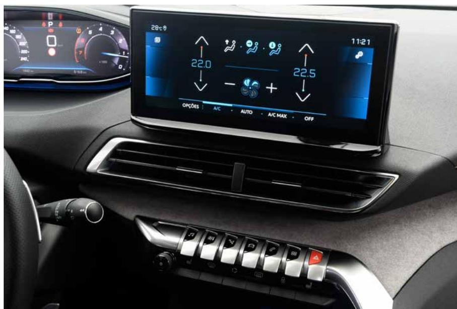
Além de central multimídia de 10", existem teclas de comando do tipo piano
