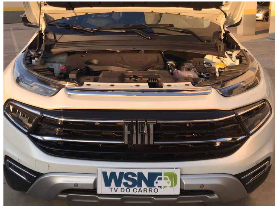
O motor 1.3 litro turbo é capaz de gerar 185 cv de potência e 270 Nm de torque a apenas 1.750 rpm
