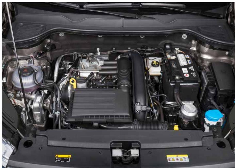
O motor é o 250 TSI Total Flex, que gera 150 cv de potência e torque de 25,5 kgfm, com etanol e/ou gasolina
