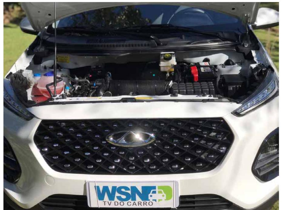
O motor 1.0 Turbo Flex do Tiggo 3x gera até 102 cv de potência e torque máximo de 17,1 kgfm
