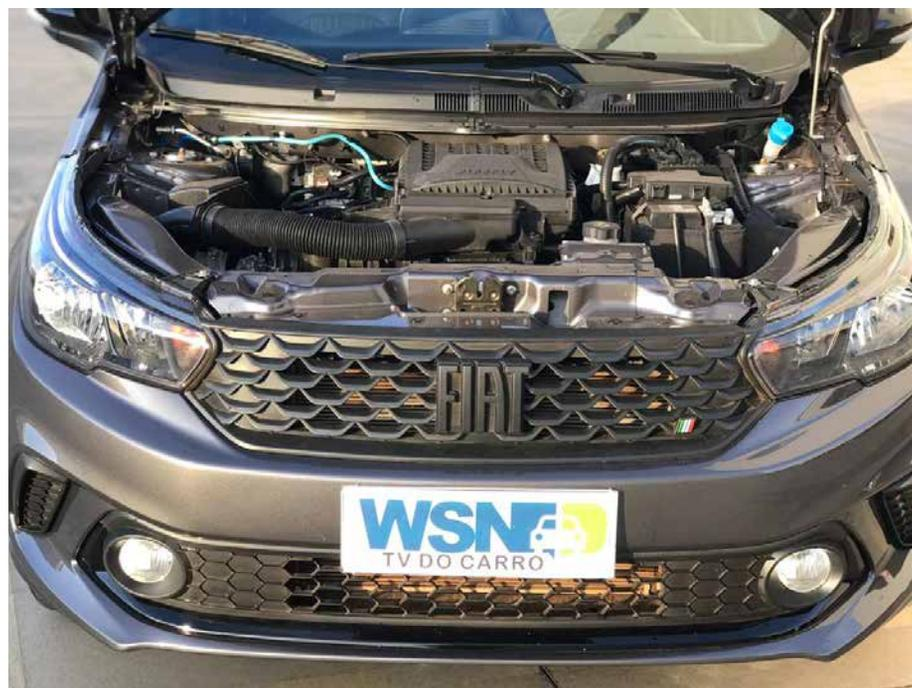
O motor Fiat flex 1.3 litro do Argo oferece 101 cv de potência com gasolina e 109 cv com álcool etílico
