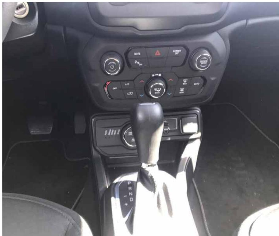
O SUV conta com câmbio automático de 9 marchas, tração 4x4, selector de terrenos com 4 modos e controle de descida
