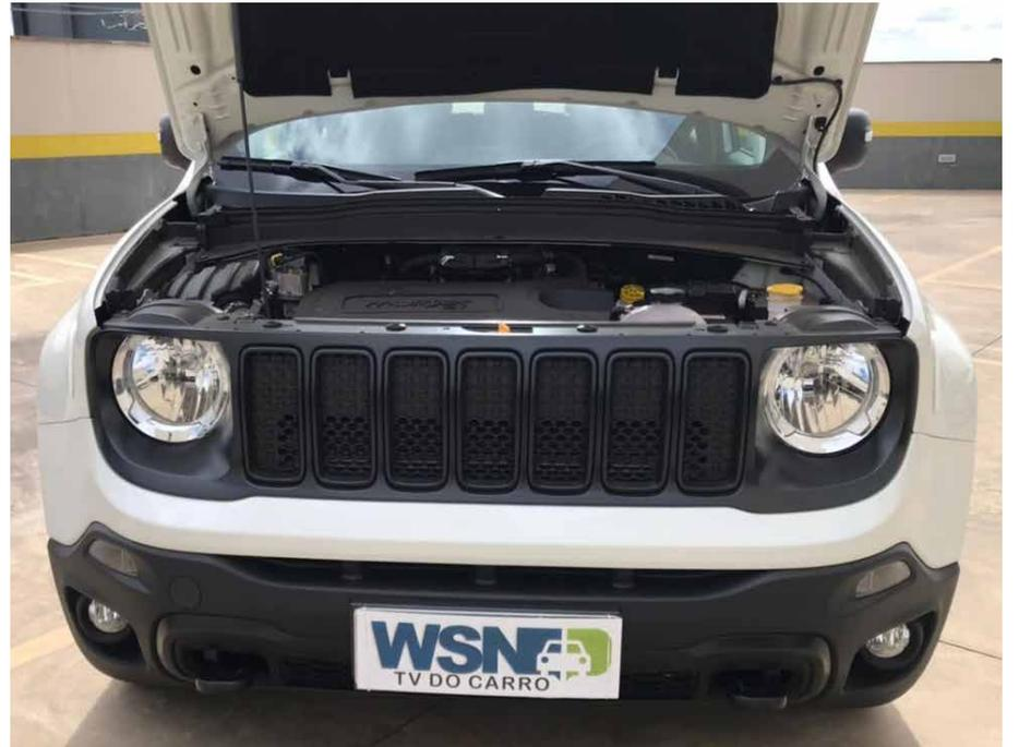
O motor turbodiesel 2.0L de 170 cv de potência e torque de 37,5 kgfm produz um bom desempenho do veículo
