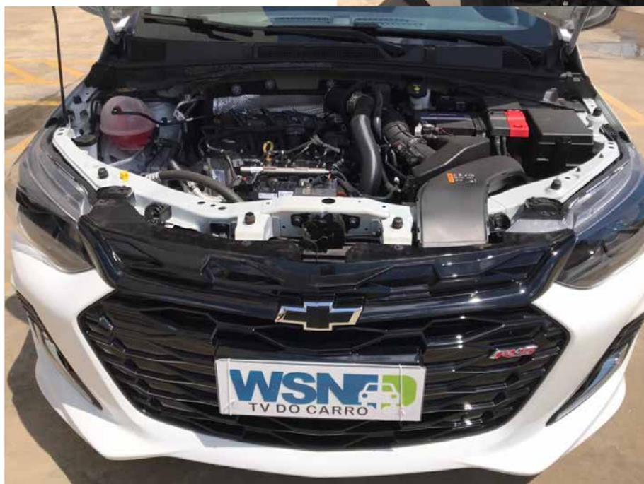
O motor é o 1.0 turbo de 3 cilindros e gera 116 CV
