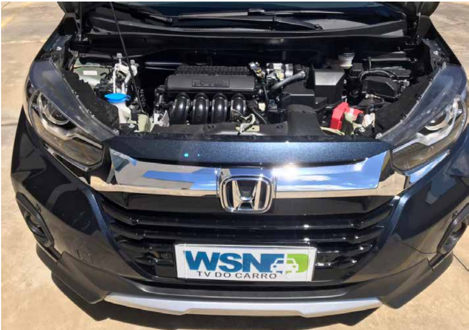
O motor continua sendo o do modelo 2020, ou seja, um 1.5 litros de 116 cv de potência e 15,3 kgfm de torque
