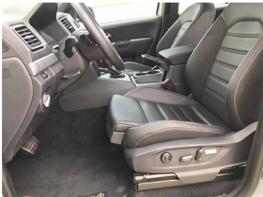
Os bancos dianteiros possuem regulagem elétrica de altura, inclinação, profundidade e acerto lombar
