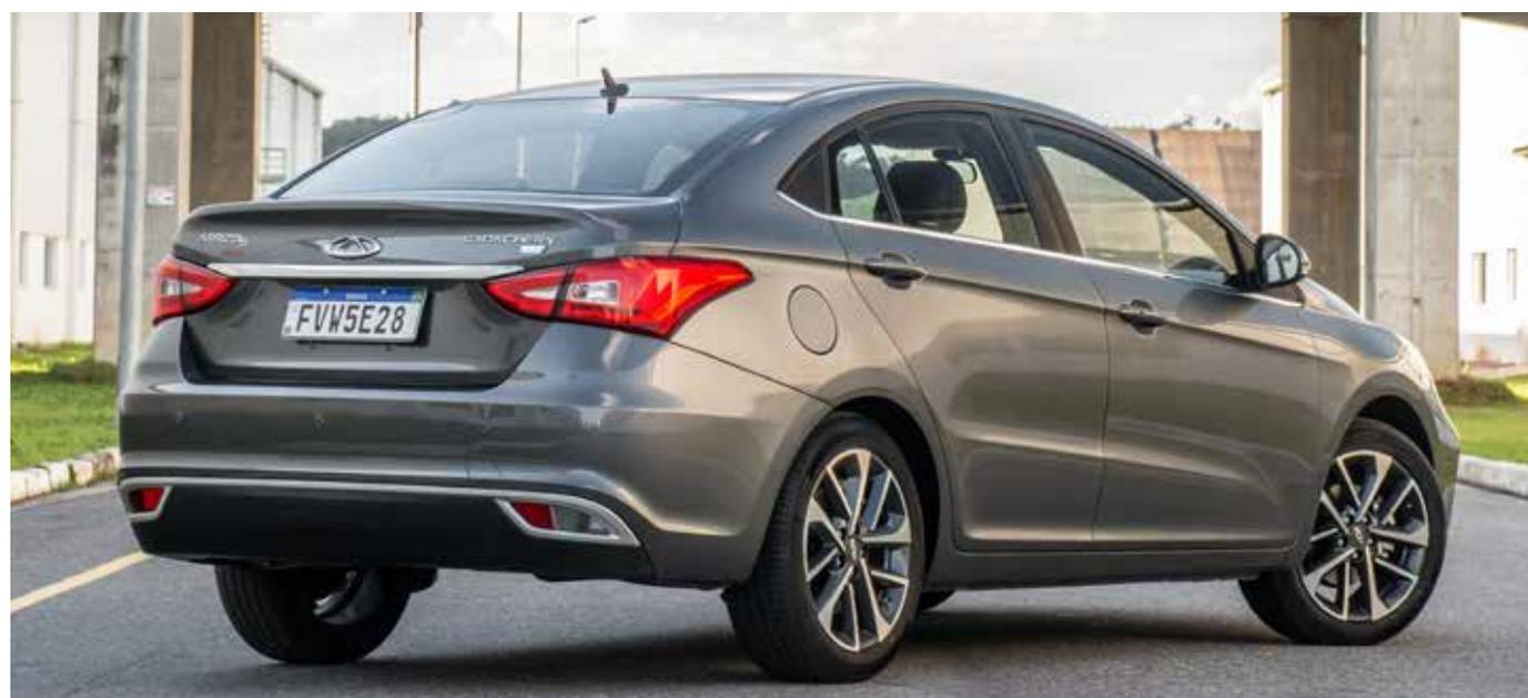
O Arrizo 5 possui motor 1.5L Turbo Flex de 150 cv de potência e 21,4 kgfm de torque, além de ser equipado com muito tecnologia
