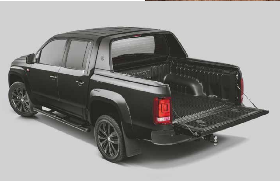
A caçamba tem uma capacidade volumétrica de 1.280 litros, podendo transportar até 1.156 quilos de carga útil
