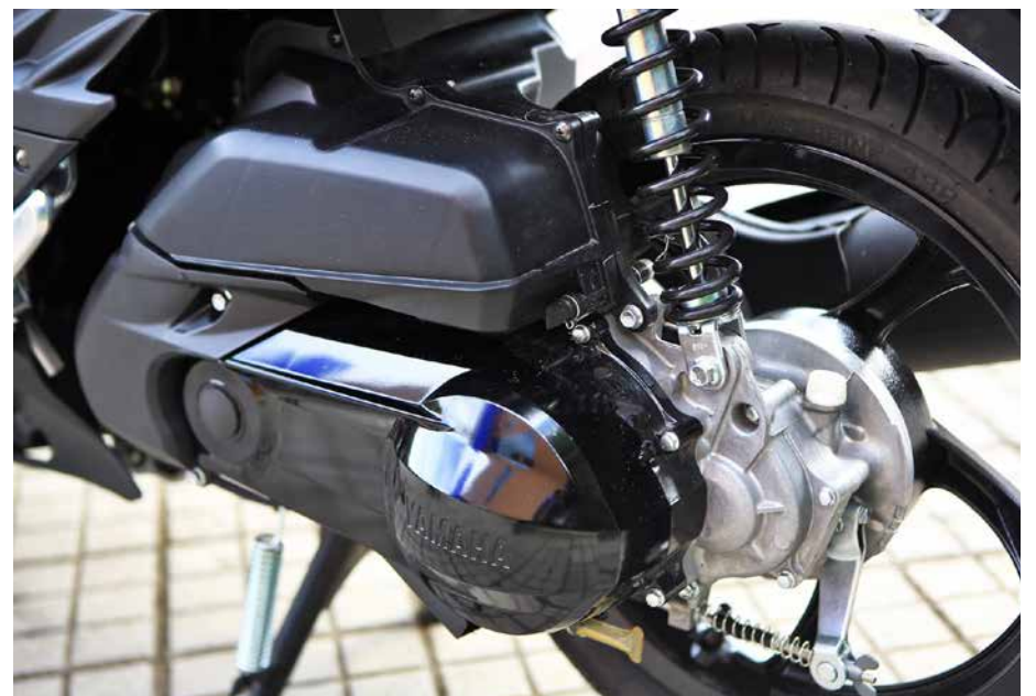
O sistema de transmissão leva a força do motor para a roda
