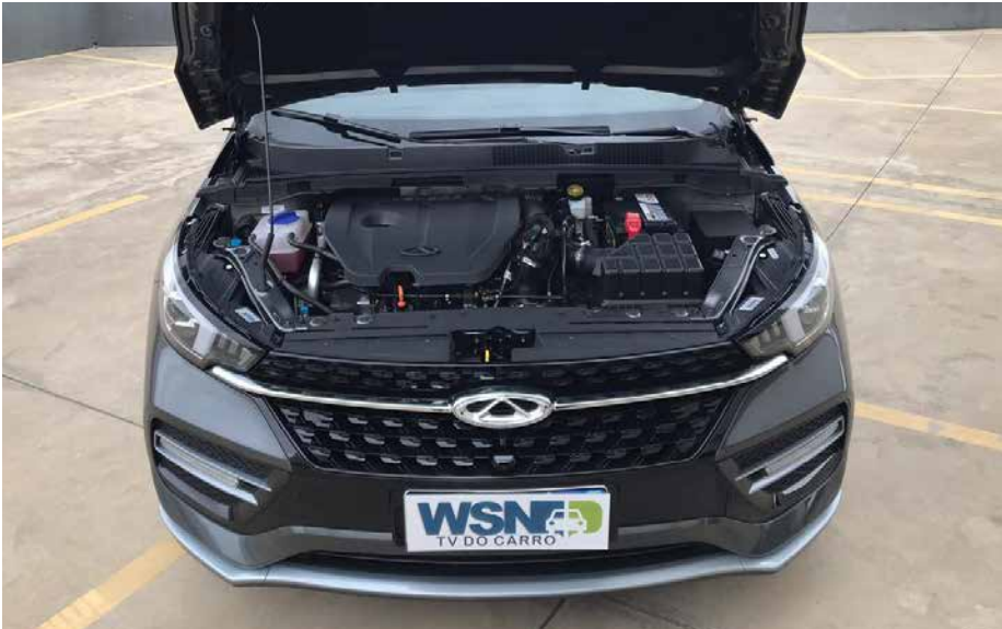
Seu motor é um 1.5 litro Flex, turbo, capaz de gerar até 150 cv de potência
