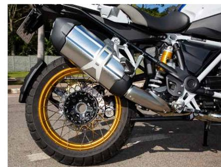
Versão Premium + tem suspensões eletrônicas com novo ajuste automático da pré-carga da mola
