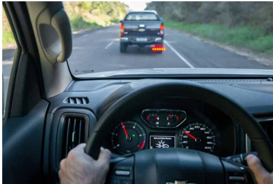
Sistema de frenagem autônoma de emergência, que freia o veículo automaticamente ao identificar uma situação de risco em sua frente
