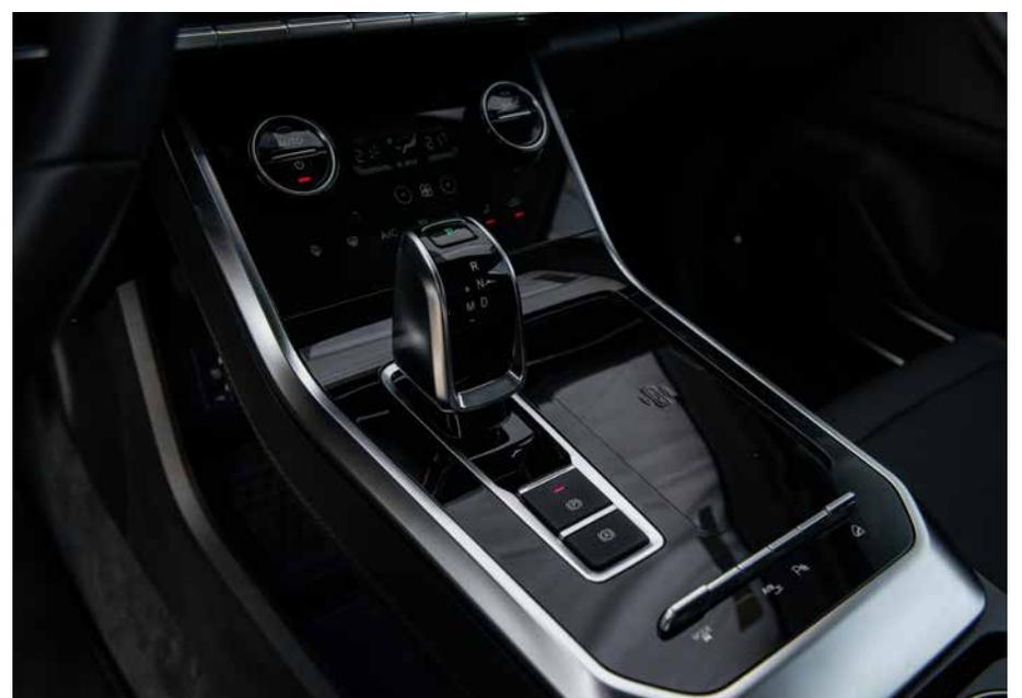
**Câmbio wet dual clutch de sete velocidades com alavanca tipo joysticks**
