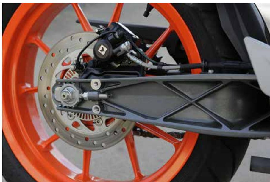
Balança é de alumínio; roda traseira tem todos os itens de um ABS, mas não tem o sistema
