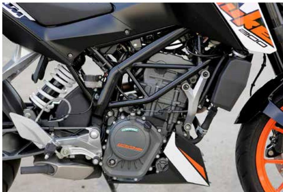
Um dos destaques do modelo é o bom desempenho do motor de 199,5 cm<sup>3</sup> e arrefecimento líquido: 25 cv
