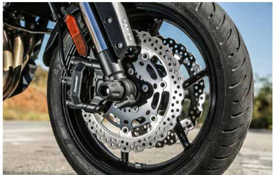
Freio a disco tem pinças radiais na dianteira com sistema ABS
