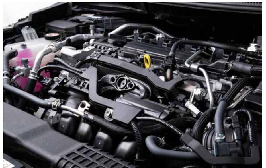
Com novo motor flex 2.0L Dynamic Force, 15% mais potente e 9% mais eficiente do que a geração anterior e no Altis Híbrido um motor a gasolina de 1.8L VVT-i 16V
