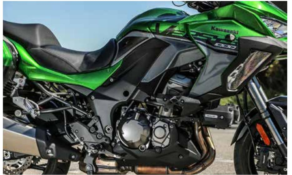
Motor de quatro cilindros e 1.043 cc tem os mesmo 120 cv, mas oferece bom torque em baixos giros
