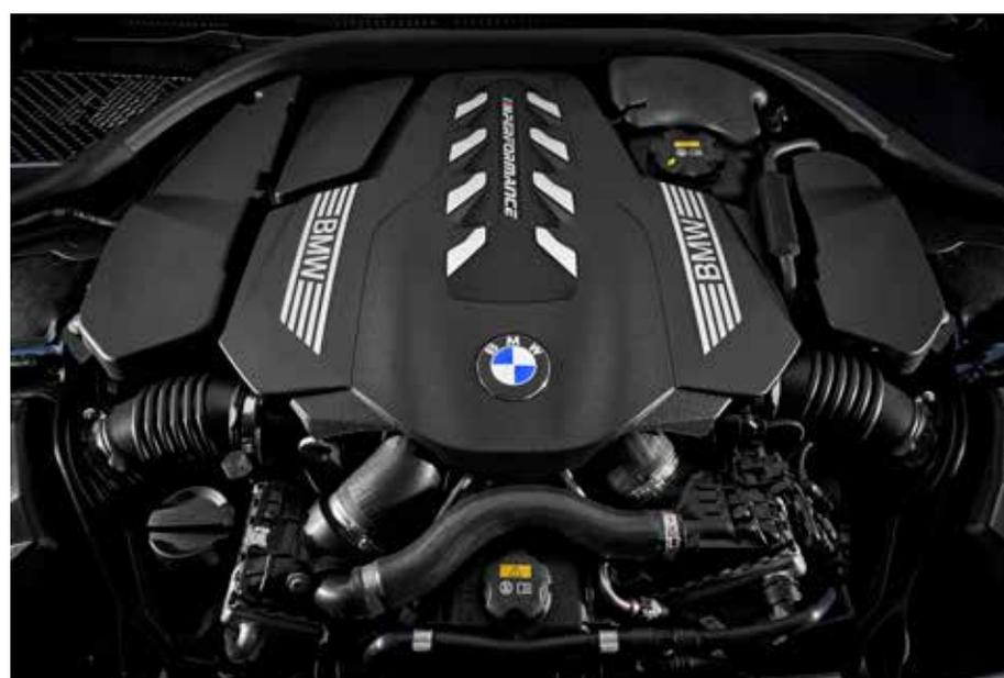
**Seu motor é 8 cilindros em V Turbo de 530CV**
