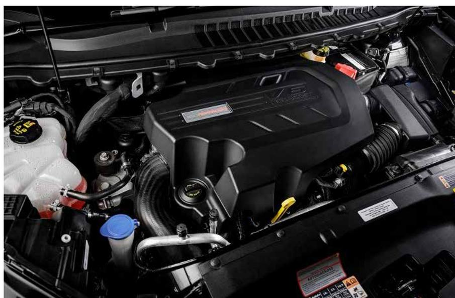
Seu motor é um V6 2.7 EcoBOOSTER com duplo turbo e gera 335 CV
