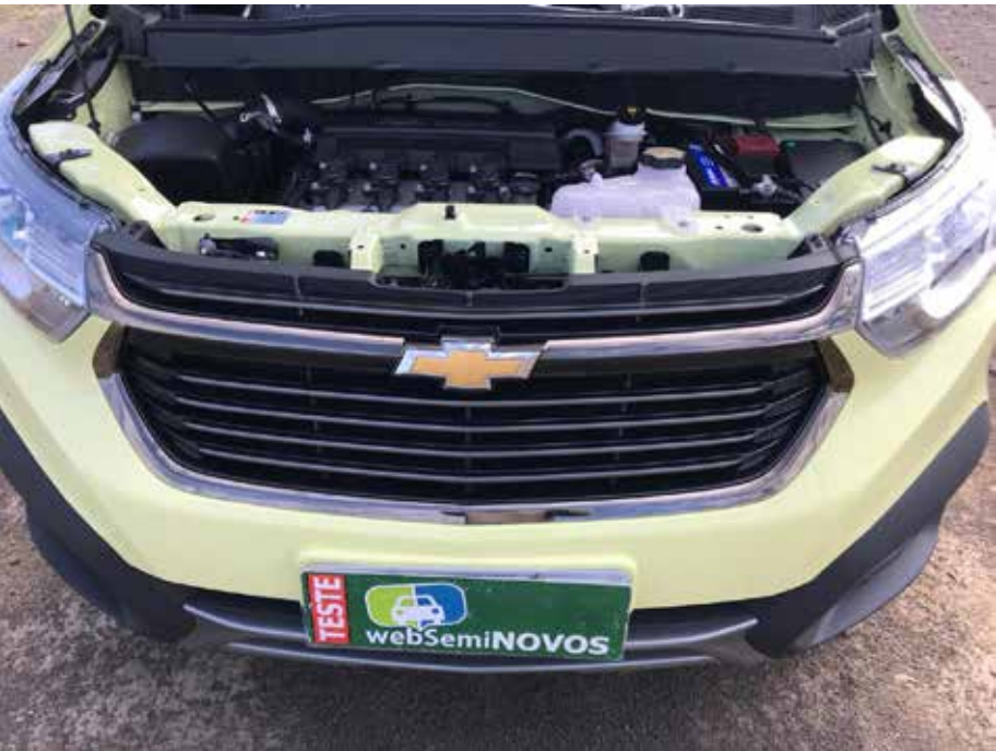
Seu motor é o Flex 1.8 ECO de até 111 cavalos de potência e 17,7 kgfm de torque
