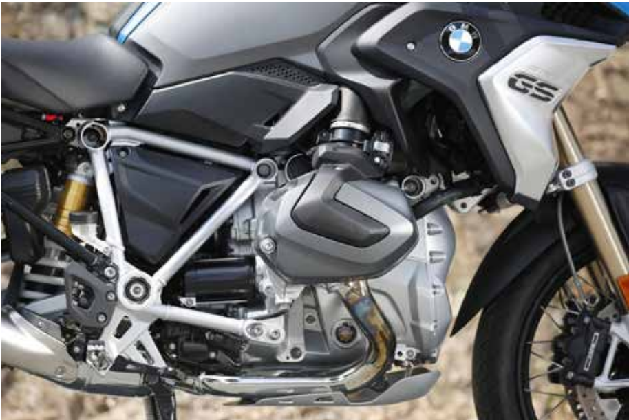
Motor agora tem 1.254 cm³, comando de válvulas variável e ganhou novas tampas no cabeçote
