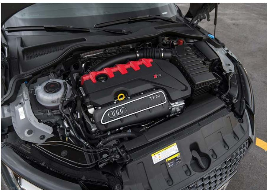
**Equipado com motor 2.5 de cinco cilindros capaz de desenvolver 400 cv**
