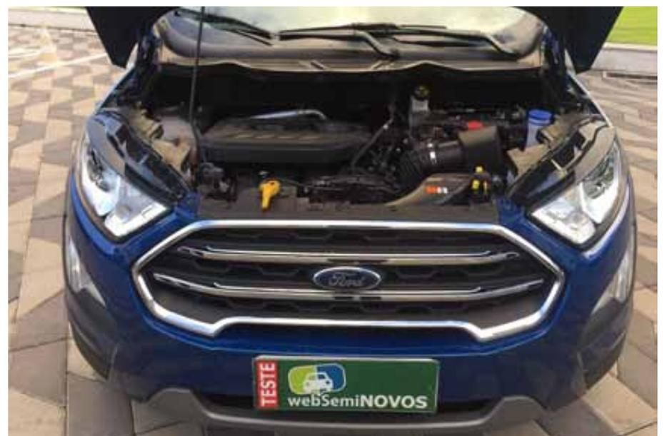
Seu motor é o 1.5 TIVCT Flex de três cilindros, de 137 cv, e o Duratec 2.0 Direct Flex, de 176 CV
