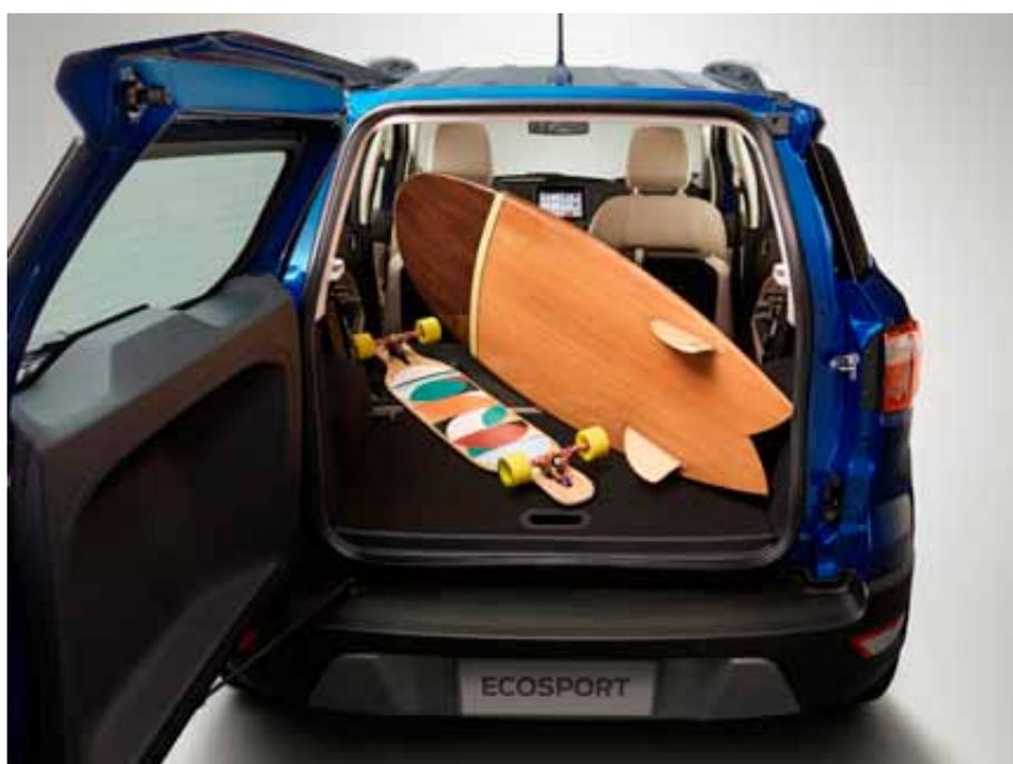
O porta-malas possui grande flexibilidade. Tem um sistema de assoalho inteligente com três configurações que permite formar uma plataforma plana com o banco traseiro rebatido e ampliar o espaço de bagagem para 1.178 litros
