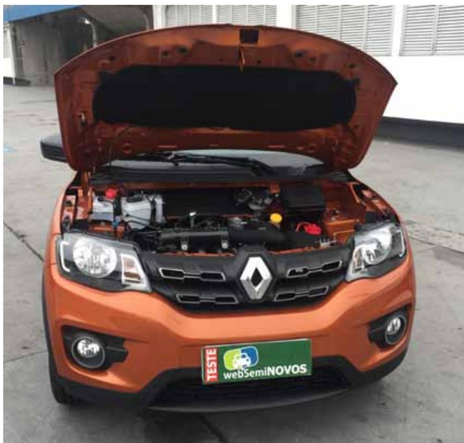
O Kwid traz o moderno motor 1.0 SCe (Smart Control Efficiency) com três cilindros, 12 válvulas, duplo comando de válvulas (DOHC) e bloco em alumínio
