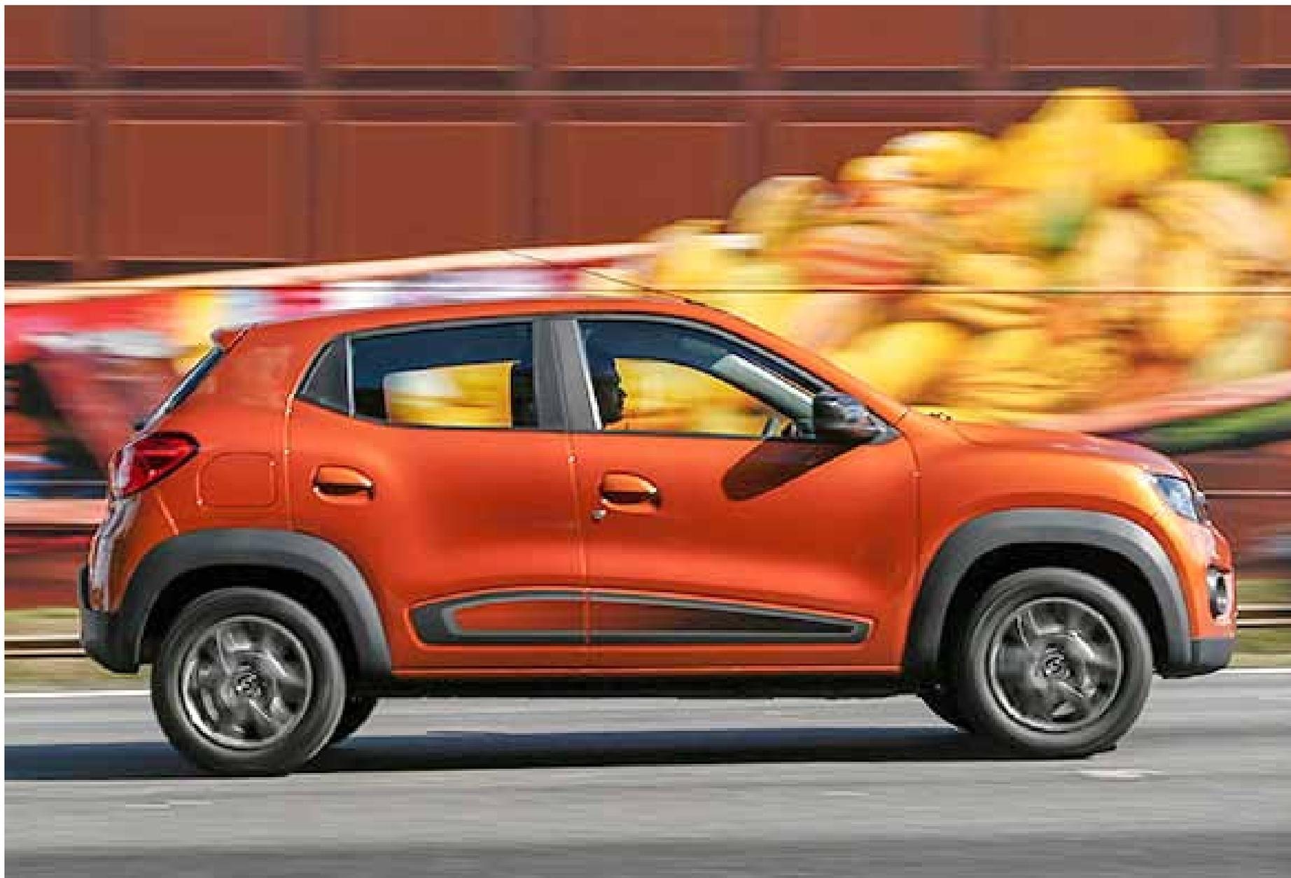
Media NAV 2.0 com câmera de ré, abertura elétrica do porta-malas, calotas e chave dobrável. O motor é o novo 1.0 SCe, o mesmo que equipa o Logan e o Sandero. Mas no Kwid, por não ter comando variável, ele desenvolve, com etanol no tanque, rende 70 cv de potência a 5.500 rpm e torque de 9,8 kgfm a 4.250 rpm.
