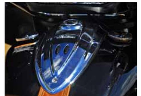
**Painel sobre o tanque traz o botão para “acordar” a Roadmaster, além de trava remota das malas**
