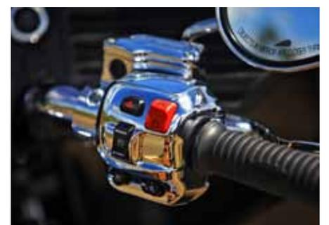
**No punho direito, o útil Cruise Control (piloto automático)**
