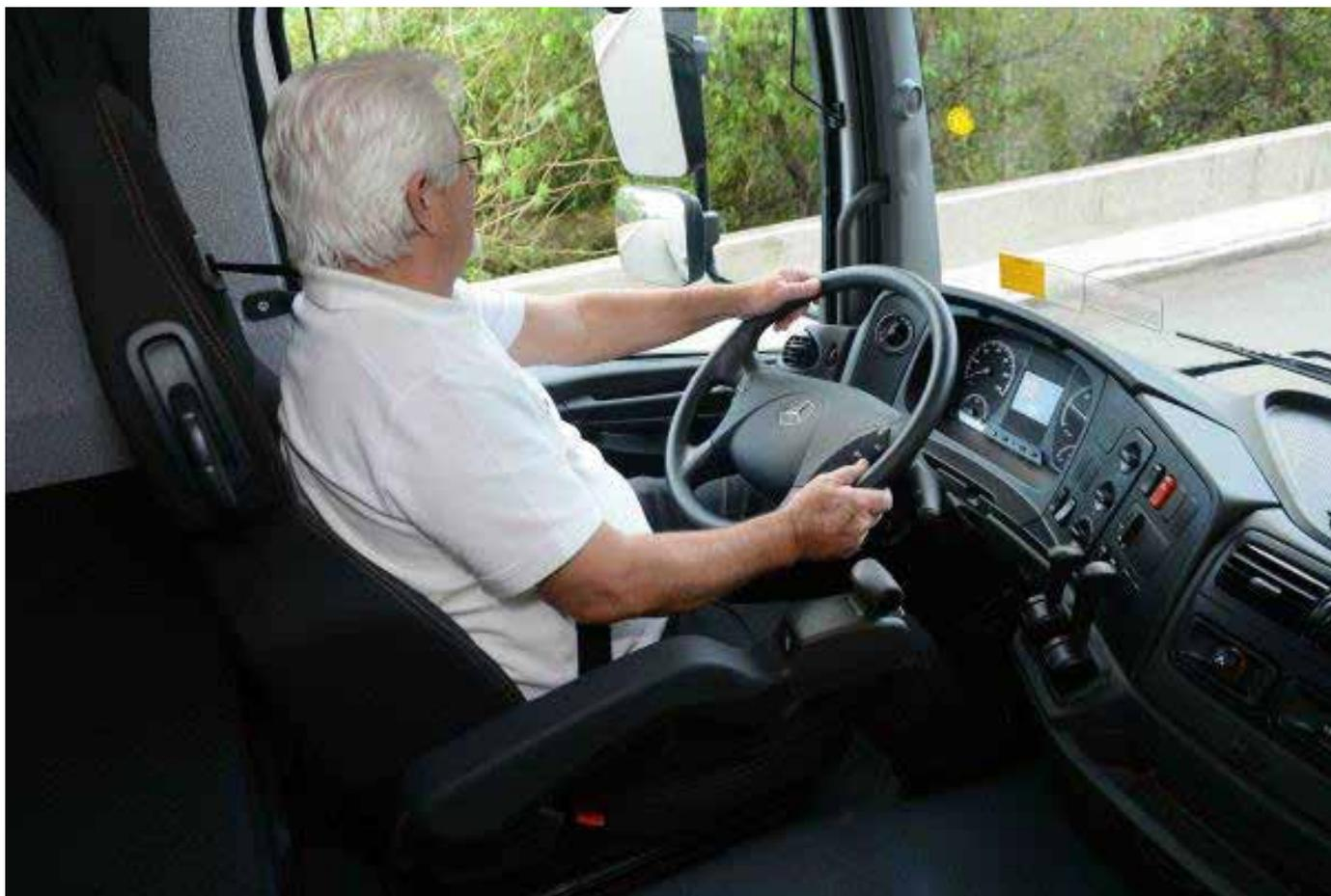
assento pneumático, ajuste da altura do banco, ajuste da inclinação do assento, ajuste do amortecedor, amortecimento horizontal, ajuste horizontal, ajuste da profundidade do assento, dois apoios de braço, baixar/levantar o encosto das costas e ajuste lombar (na versão “Conforto”).
