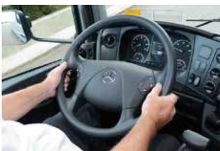
**Volante multifuncional e quatro raios e dois conjuntos de botões, um em cada lado, o volante conta com teclas de acionamento para os comandos do painel de instrumentos**
