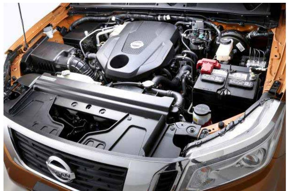
**O moderno motor diesel 2.3 biturbo, que desenvolve 190 cavalos de potência e entrega 45,9 kgfm de torque**
