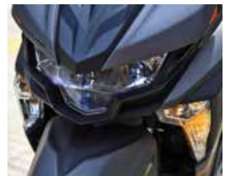
**O conjunto óptico dianteiro conta com iluminação em LED**
