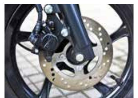
**O Neo 125 conta com sistema UBS, que distribui a frenagem em ambas as rodas**
