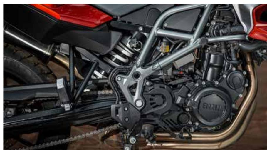
O motor de dois cilindros da F 700 GS oferece 75 cavalos de potência máxima
