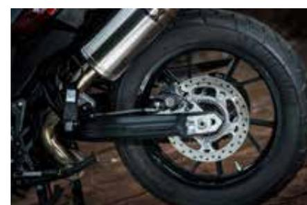
A parte traseira traz balança de alumínio com monoamortecedor e freio a disco
