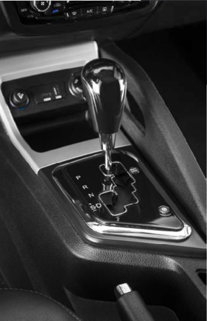
O câmbio da Punch adotado pelo JAC T5 CVT também incorpora a função WIN
