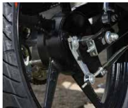
Ajuste do freio a tambor deve ser feito no varão. Ao chegar no limite, é hora de trocar as lonas
