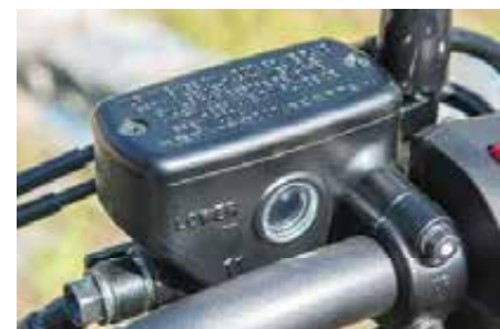
Confira o nível do fluido de freio (a disco) periodicamente: troca deve ser feita todo ano
