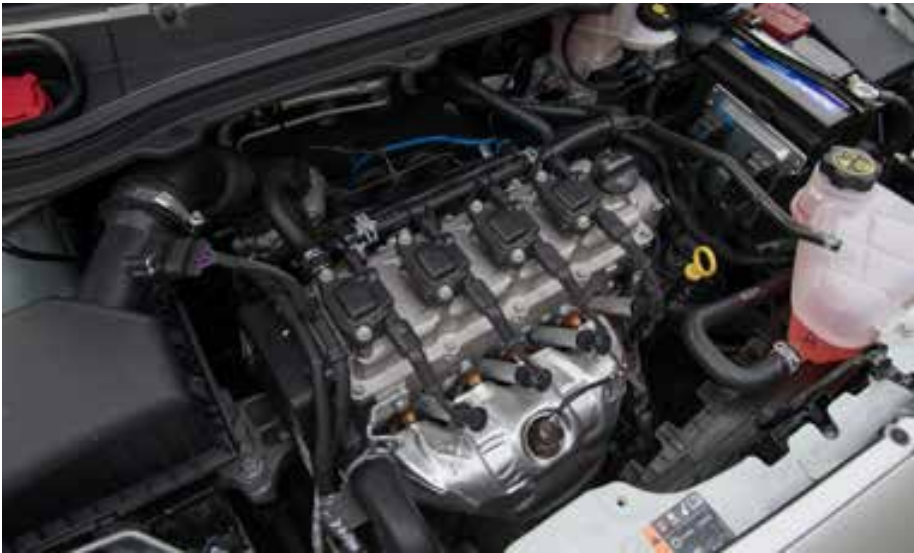
O motor Chevrolet é de nova geração, o 1.0 SPE/4 ECO. Ele diferencia-se pelos pistões, bielas e anéis redesenhados e mais leves
