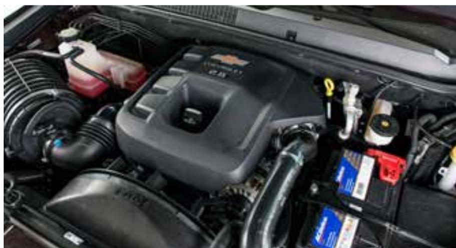
**Além de uma opção 2.8 turbodiesel com 200 cavalos de potência e 51 kgfm de torque, o Novo Trailblazer é ofertado com a nova geração do propulsor 3.6 V6**
