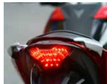
**Lanterna traseira é semelhante a da MT-07 com LEDs**
