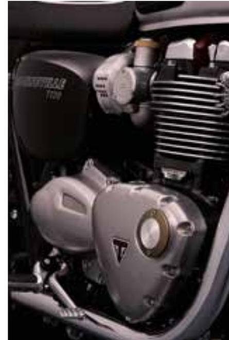
**T 120 e T 120 Black têm o mesmo bicilíndrico de 1200cc, arrefecimento líquido e 80 cv**
