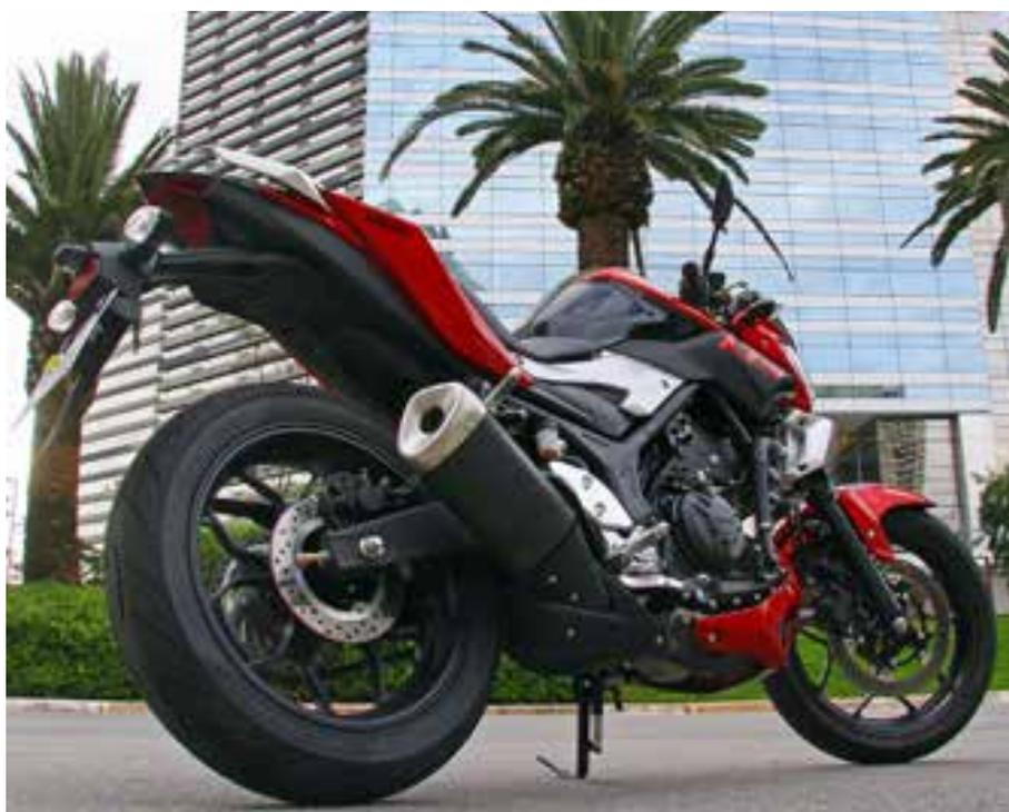
MT-03 tem rodas de liga-leve de 17 polegadas, calçadas com pneus sem câmara
