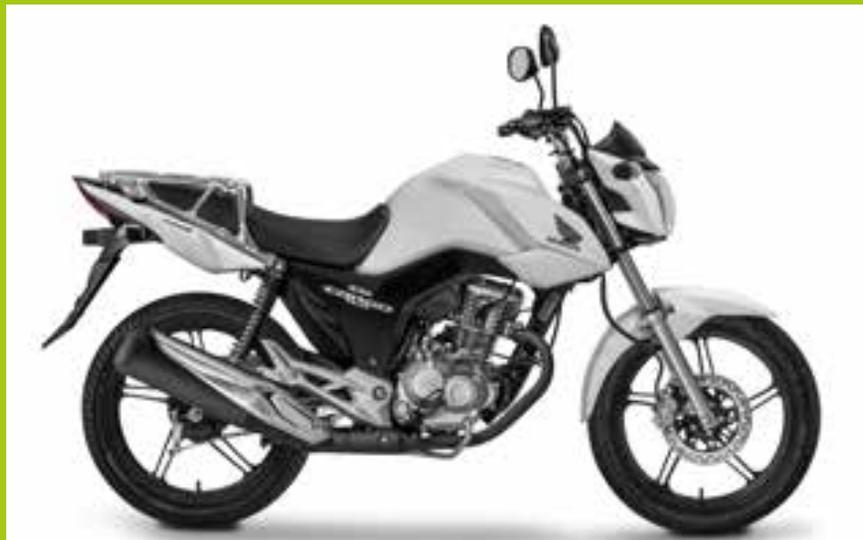
Para atender as necessidades de freteristas e profissionais liberais a Honda lançou a linha Cargo 2016 nas versões CG 125i Cargo (gasolina) e CG 160 Cargo (Flex). A nova família traz novidades na motorização e detalhes exclusivos como assento duplo, tanques redesenhados, nova tampa de combustível e escapamento remodelado. A principal novidade da linha de entrada é a alimentação por injeção eletrônica de combustível. Na 125cc,
