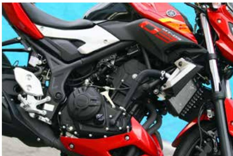
**Motor bicilíndrico de 321 cm<sup>3</sup> tem comando duplo e refrigeração líquida. Produz 42 cv a 10.750 rpm**
