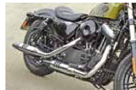
Refrigeração a ar, acionamento do comando por varetas atestam a receita clássica da Harley-Davidson
