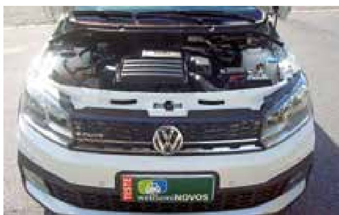
O motor é um 1.6 MSI, quatro cilindros e 16 válvulas (4 válvulas por cilindro) e utiliza o sistema de partida a frio
