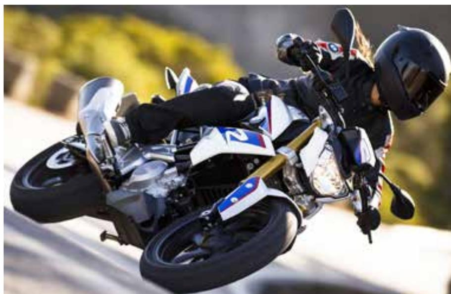
A pequena BMW traz um inédito motor monocilíndrico de 313 cm<sup>3</sup>, que gera 34,4 cv de potência máxima
