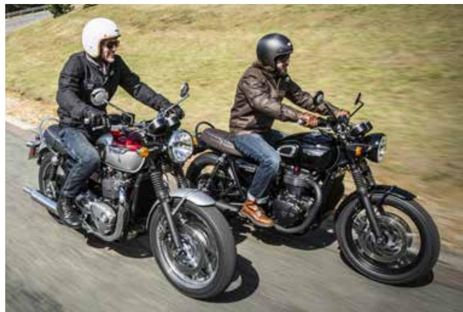
Novas Bonneville T 120 têm motor de 1200cc “hi-torque” e têm controle de tração e modos de pilotagem
