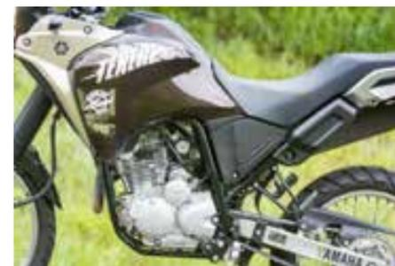
**O motor recebeu novo mapeamento e atinge a potência máxima de 20,9 cv abastecido com etanol**
