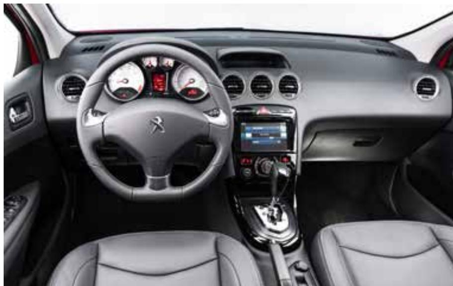
O 308 conta com um novo volante revestido em couro, coluna de direção com regulagem de altura e profundidade e com comando do rádio, que integra ainda o limitador e o regulador de velocidade
