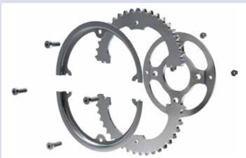
Trocar a coroa sem a necessidade da retirada da roda é a proposta da Riffel ao apresentar a coroa "bipartida". O novo produto possui a parte dentada da coroa dividida em dois segmentos (por isso o nome 'bipartida') e permite ao mecânico substituir facilmente o conjunto trocando apenas a parte desgastada. Segundo a empresa, a nova coroa irá oferecer mais praticidade aos mecânicos, com redução de até 50% no tempo de troca da peça. Informações: <http://www.riffel.com.br/ID>
