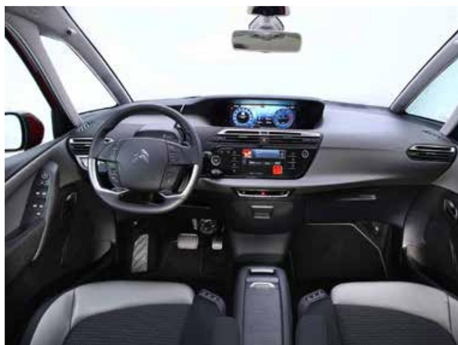
O painel do Novo Citroën C4 Picasso é estruturado em torno de duas telas: uma tela tátil de 7" e uma tela panorâmica de 12" de alta definição
