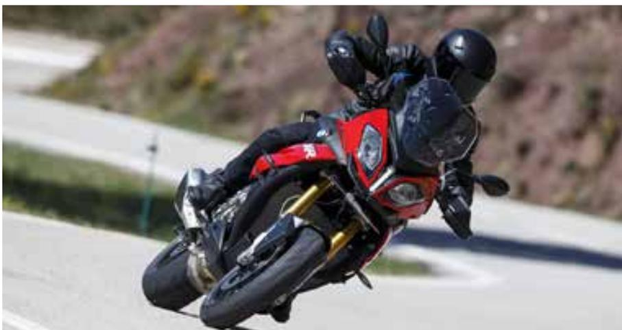
A receita alemã para agradar a esse consumidor é a S 1000 XR. Montada em Manaus, a moto compartilha o motor de quatro cilindros da superesportiva S 1000RR, porém amansado: ao invés de 200 cv, na nova XR o motor oferece 160 cv de potência. Além disso, a nova XR traz suspensões de longo curso e uma posição de pilotagem mais ereta.
