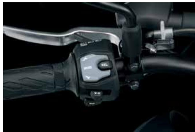
O controle de tração e os modos de pilotagem podem ser habilitados por meio do punho esquerdo
