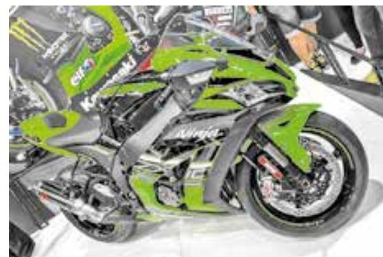
O modelo usa motor de 998 cc com refrigeração líquida, 4 cilindros em linha e supera os 210 cv de potência máxima. O modelo conta com quadro em alumínio e sistema de freios desenvolvido pela Brembo que é, praticamente, o de uma moto de competição. Na suspensão dianteira a esportiva traz novo garfo desenvolvido em conjunto com a Showa no campeonato mundial de Superbike. Ou seja, é uma moto de pista travestida para a rua.
