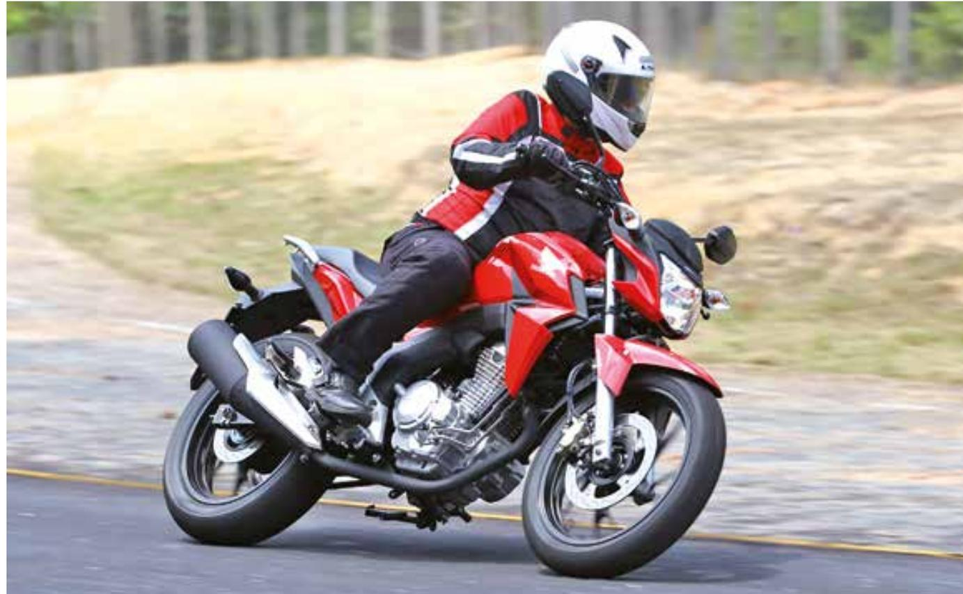
por injeção eletrônica e já está adequado as normas do Promot 4, que entra em vigor em janeiro de 2016. Câmbio de seis marchas completa o conjunto mecânico, que é fixado no chassi do tipo diamante, moldado em tubos de aço.
